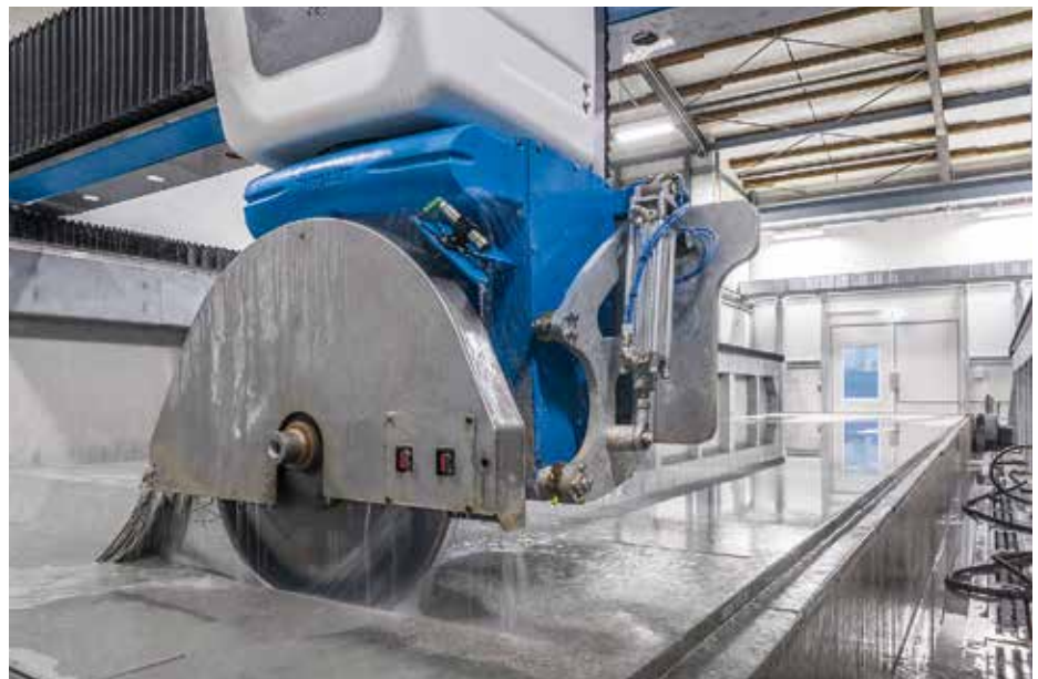
60 x 7 Meter ist der sogenannte Sägetisch groß. Hier werden die neuen Carbonbeton-Platten in Grundmaßen von 13 x 3,50 oder 17 x 3,50 Meter ausgesägt.
