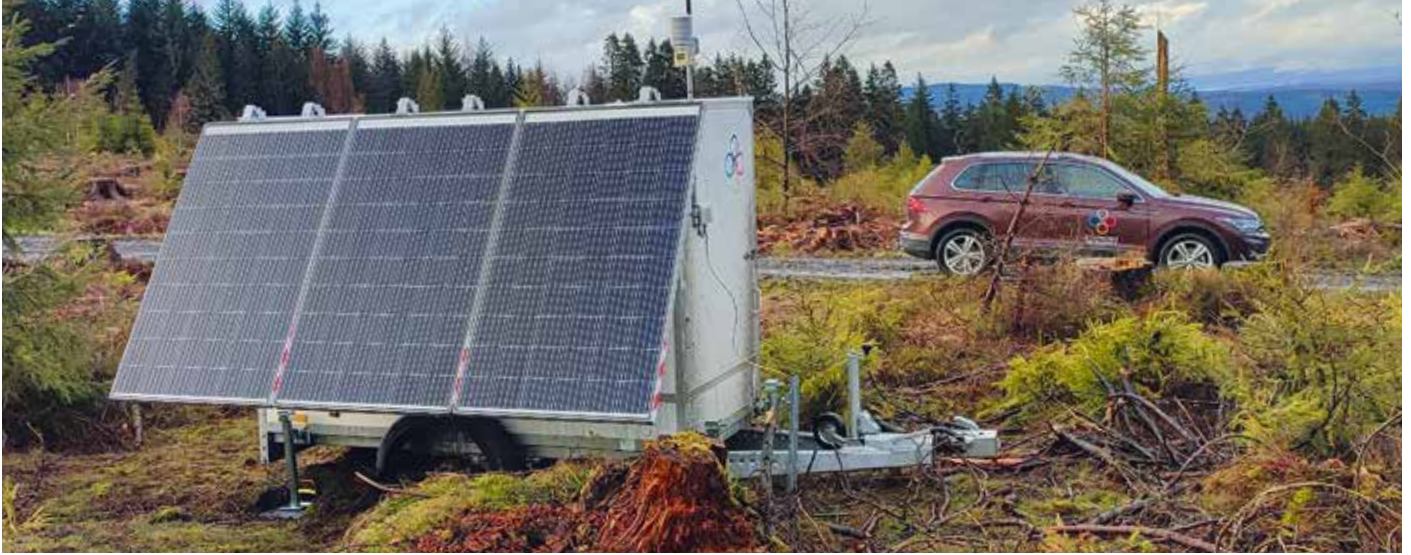
Optische Windmessung nach dem LIDAR-Verfahren durch den Deutschen Bauservice.
