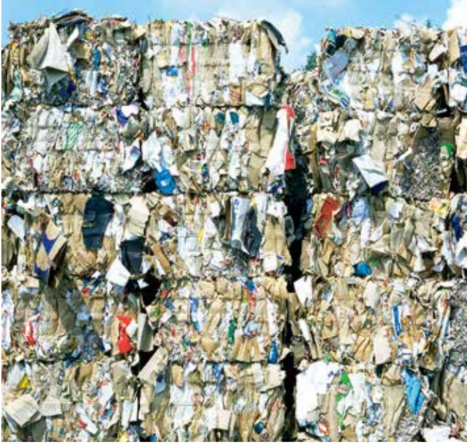
Papierballen nach der Verdichtung in der Ballenpresse.
