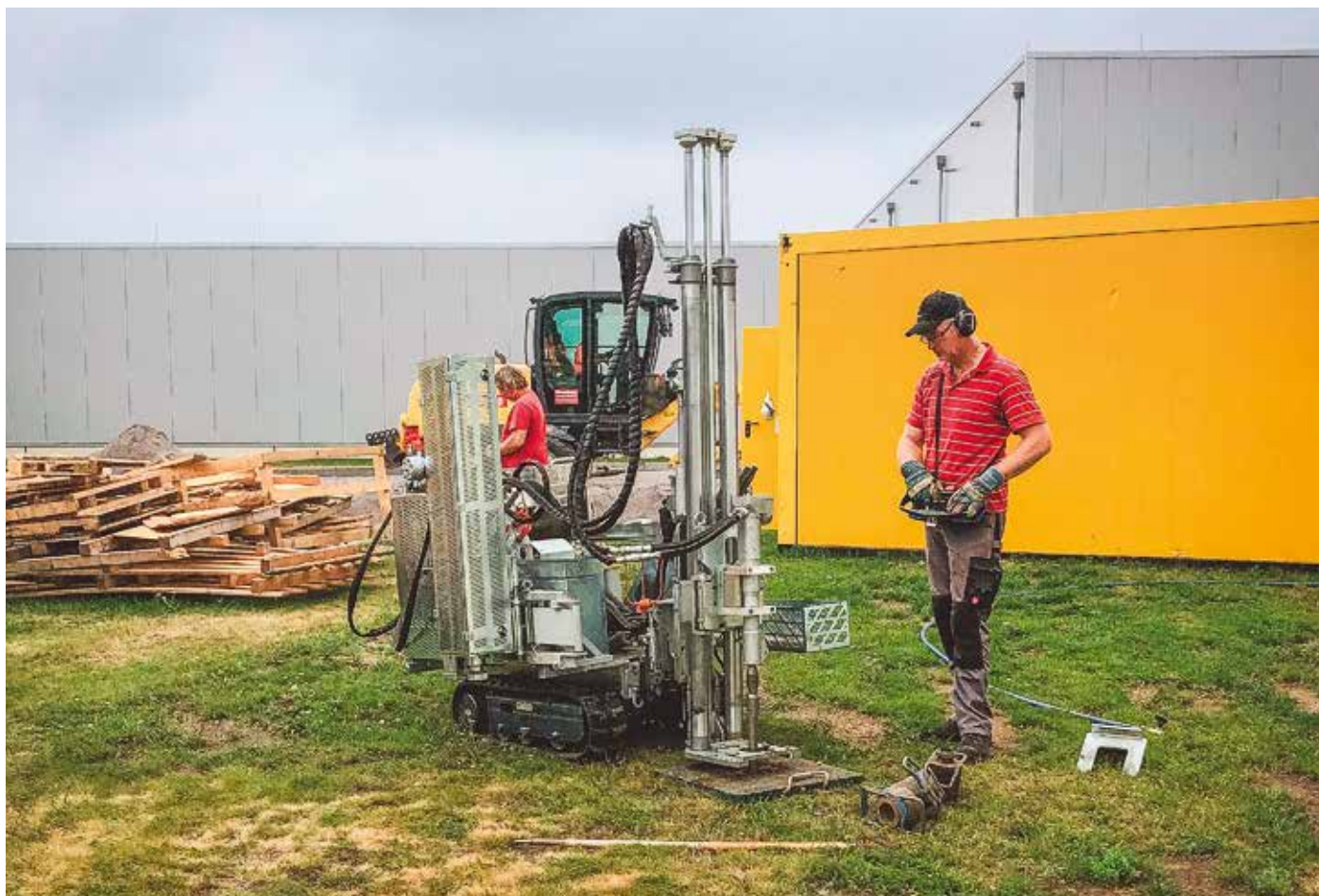
Die Gewinnung von Bodenproben mittels Raupenbohrgerät.
